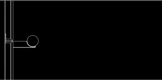
Vertikální řez boční stěny, strana madla držák. Podpěra madla.
