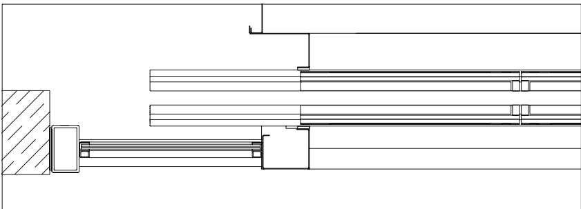
Horizontální řez kabinovými a šachetními dveřmi, Celoskleněné dveře se skleněným portálem P7-G
