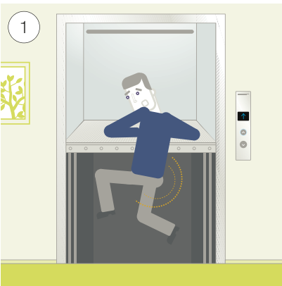
Zástěra pod klecí výtahu
