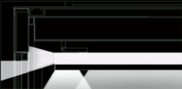
Svislý řez stropem kabiny s osazeným světlem LD5X, světelné schéma světelného rámu, středová plocha osvětlená.
