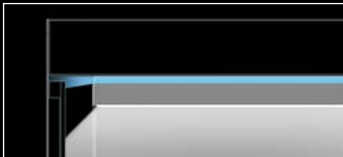
Vertikální řez světelným stropem LD8 LED RGB. Funkční schéma přímé - nepřímé osvětlení LED neutrální bílá, LED RGB řízení světla
