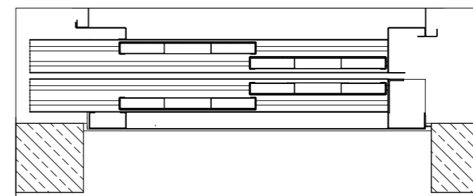
Horizontální řez kabinové a šachetní dveře s dveřní zárubní / napojení na zed' T1.
