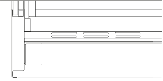
Broušený nerez řez zadní stěnou / podlahou. Okopová lišta. Skryté velkoryse dimenzované větrání kabiny pod okopovou lištou.
