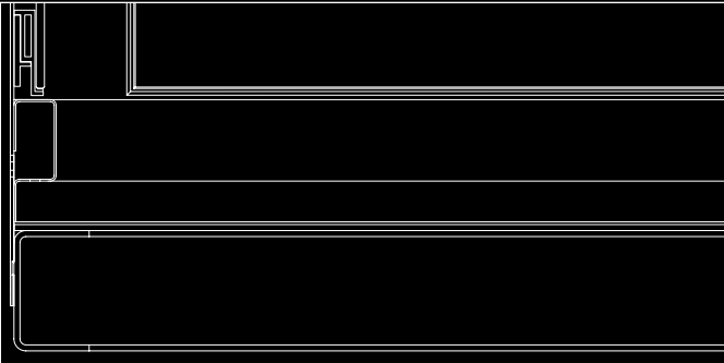
Svislý řez zadní stěnou / podlahou. Výtah CG-I Color Glas®, rámování CG Design 3.
