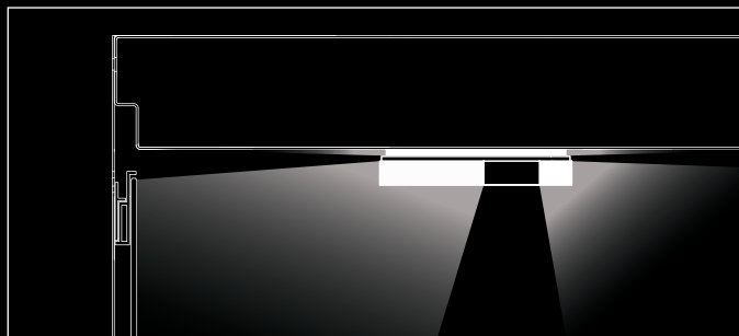
Svislý řez LD7-NEO-LED Wallwasheru. Funkční schéma přímého a nepřímého osvětlení.
